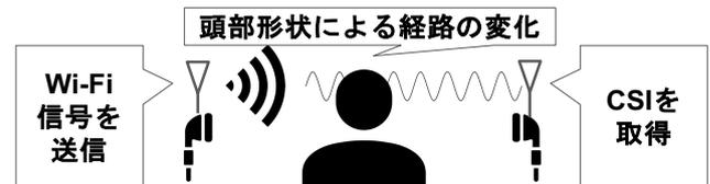
図 1: CSI を用いた頭部による個人認証手法の概要
