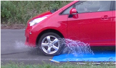
図 13 側方カメラから水はねを観測した様子 Fig. 13 Water-splash captured from a side view camera.
