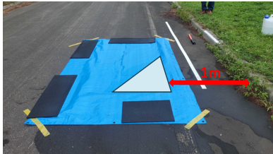
図 10 深さ 2 cm の人工水たまり Fig. 10 Artificial puddle with 2 cm deep.
